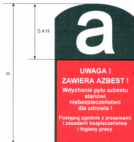
Oznakowanie wyrobów i odpadów zawierających azbest
